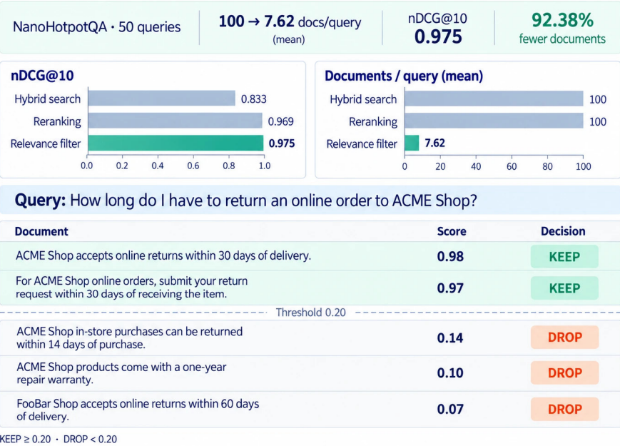
图 8-4 上半张图是那组数字：混合检索 0.833，Jev 重排 0.969，再按阈值过滤 0.975，每个查询平均只剩 7.62 篇。下半张是一个例子，0.14 和 0.10 的段落都被丢掉。图片来自 jev-reranker 的介绍文章
