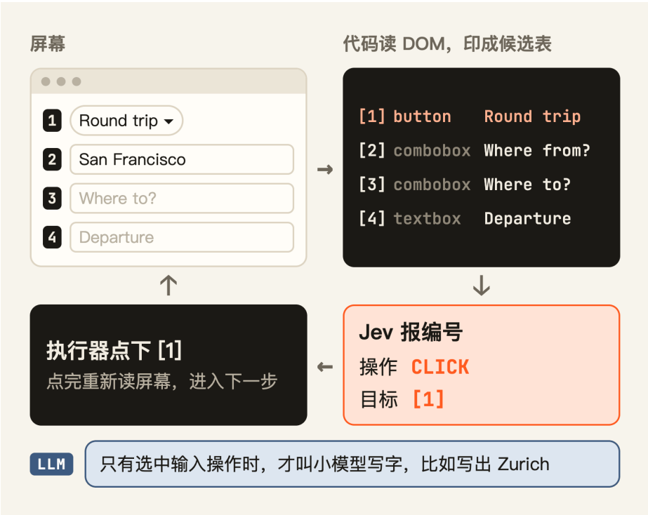
图 6-1 屏幕先印成带编号的菜单，Jev 只需要报编号
